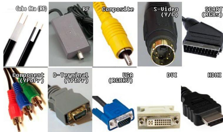
Inicialmente o aparelho de TV possuía uma única entrada de sinal, basicamente dois pequenos parafusos onde eram enroladas as pontas dos dois filamentos do cabo fita que descia da antena externa. Posteriormente uma segunda entrada deste mesmo tipo foi incorporada, permitindo conectar também uma antena interna ou antenas independentes de VHF e UHF.
