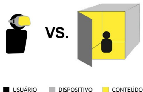
Figura 2: diferentes interfaces com a realidade virtual imersiva (HMD e CAVE)
